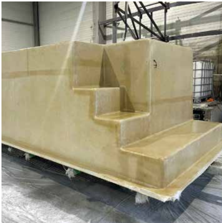
2/ Moulage par stratification
